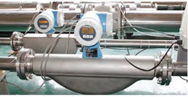
DN65-DN300 Gravimetric & Standard Meter Liquid Flow Meter Calibration Device
